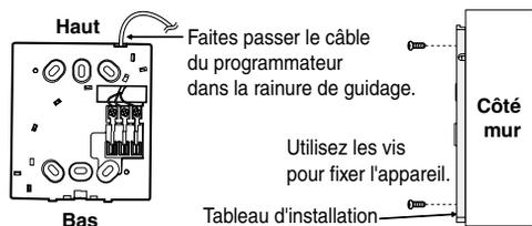
**4. Après avoir engagé la partie supérieure de la télécommande sur le tableau d'installation, comme indiqué sur la figure ci-contre, appuyez sur la partie inférieure pour fixer la télécommande au tableau.**
